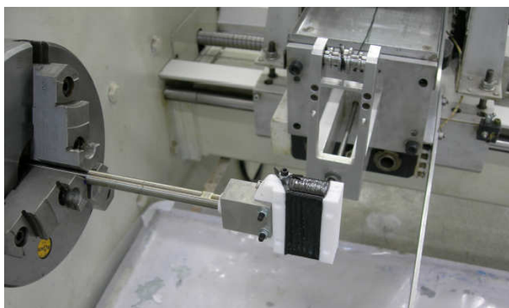
FIGURA 4.11 – Enrolamento filamental do corpo-de-prova de compósito.
