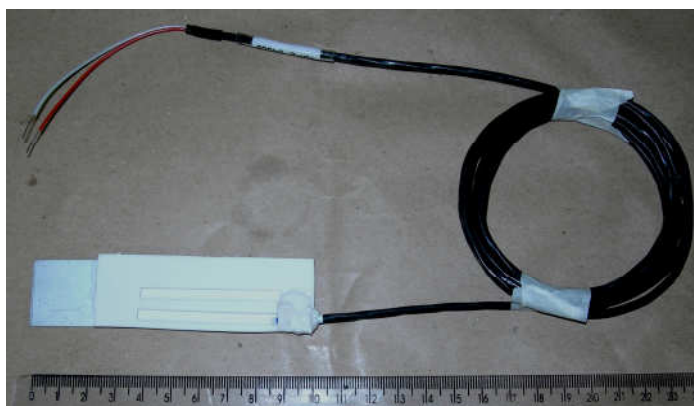
FIGURA 4.23 – Termorresistência PT 100 no molde de matriz.
